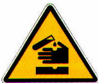
sostanze corrosive o irritanti
